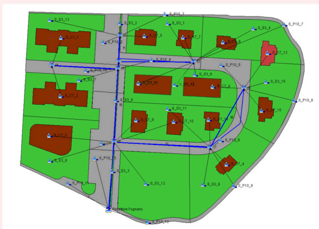
Figura 4 – schema dell'area di lottizzazione nello stato di progetto utilizzato per il modello di calcolo in HEC-HMS
