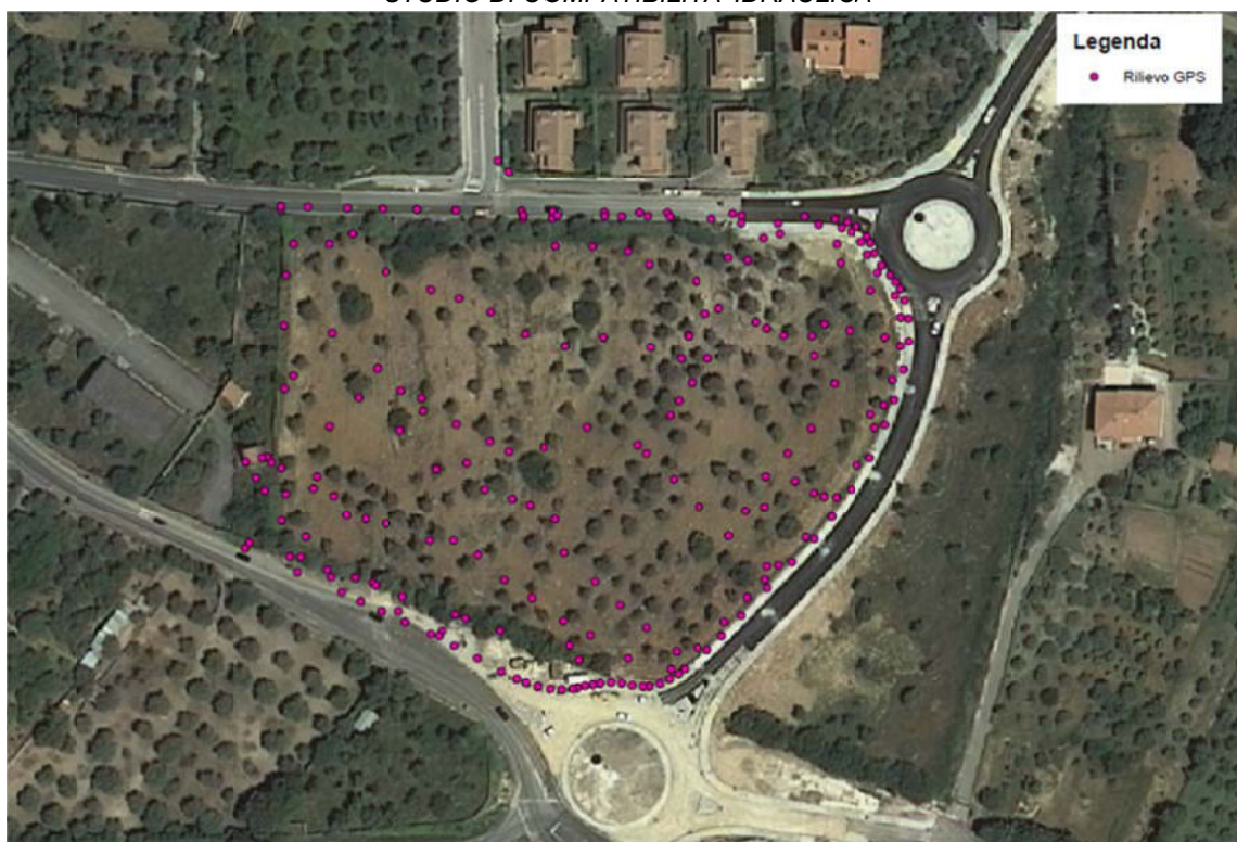
Figura 6 – individuazione dei punti del rilievo topografico svolto con tecnica GPS
