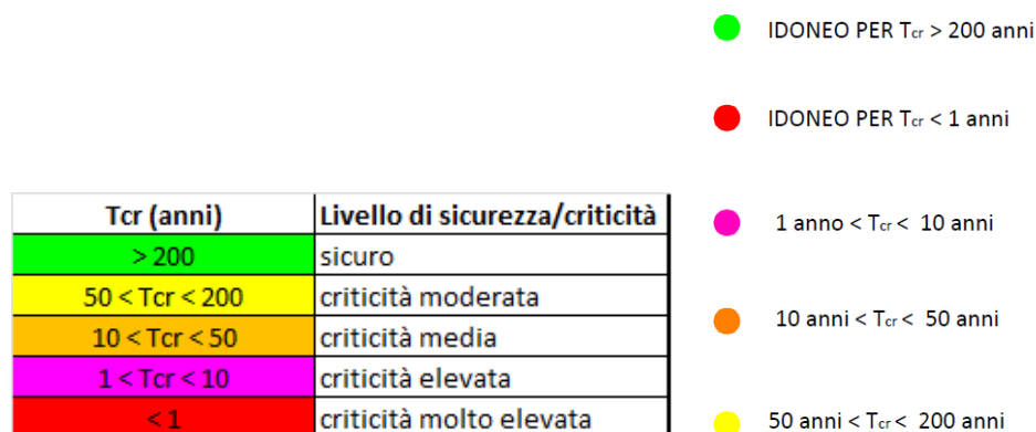
Figura 1–fasce di sicurezza/criticità a seguito di verifiche idrauliche
